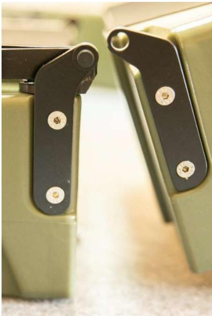
Das fehlende kurze Innenscharnier montieren sie mit weiteren 2 Stk. Innensechskantschrauben. Der erste hintere Schwimmkörper ist montiert. Verfahren sie mit der zweiten Seite gleich.
